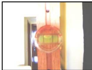
FIGURA 13 - Nível de bolha afixado na parte lateral do tabuleiro
